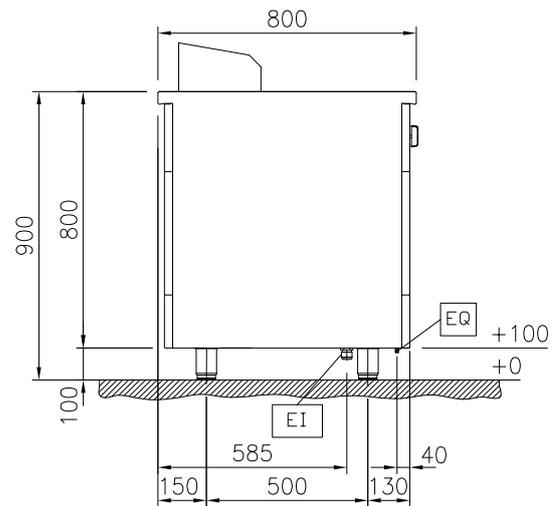
EI = Conexión eléctrica (energía)
